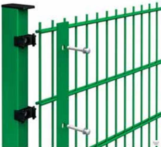
Das **System SIGMA** - auf Pfosten mit einem Querschnitt von 60 x 40 mm. Die Gitterzäune werden auf Montagehalterungen, die sich unter jeder Reihe der horizontalen Doppelstäbe befinden, mit Hilfe von Leisten montiert.
