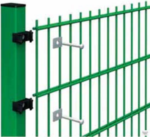
Das **System DELTA** - auf Pfosten mit einem Querschnitt von 60 x 40 mm. Die Gitterzäune werden auf Montagehalterungen, die sich unter jeder Reihe der horizontalen Doppelstäbe befinden, aufgehängt und mit Hilfe von Druckplatten montiert.
