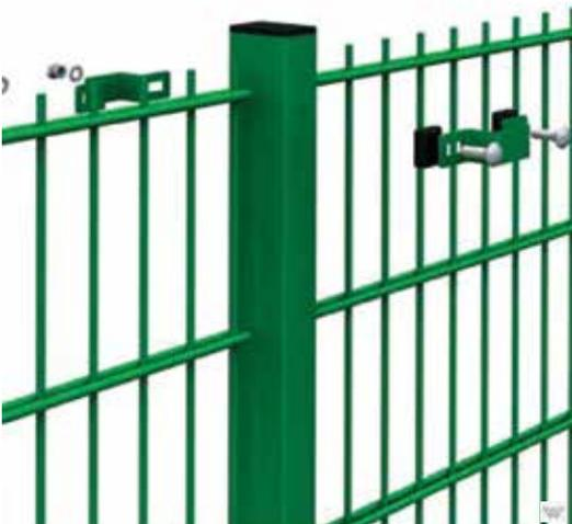
Das **System OMEGA** - auf Pfosten mit einem Querschnitt von 60 x 40 mm. Die Montage der Elemente an den Seiten des Pfostens erfolgt mit Hilfe von zweiteiligen, rechteckigen Schellen, die mit Hilfe von rostfreien Schrauben und Muttern miteinander verbunden werden.
